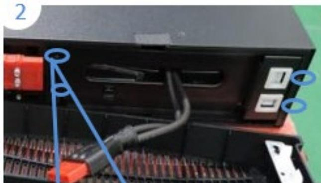
Batterieabdeckung mit Schrauben
